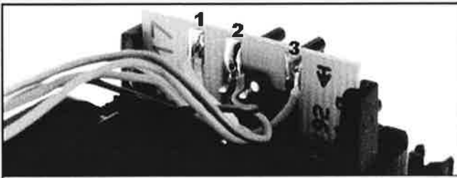
Plaquette porte-éclairage avant : 1 = jaune, 2 = gris, 3 = orange (commun).
